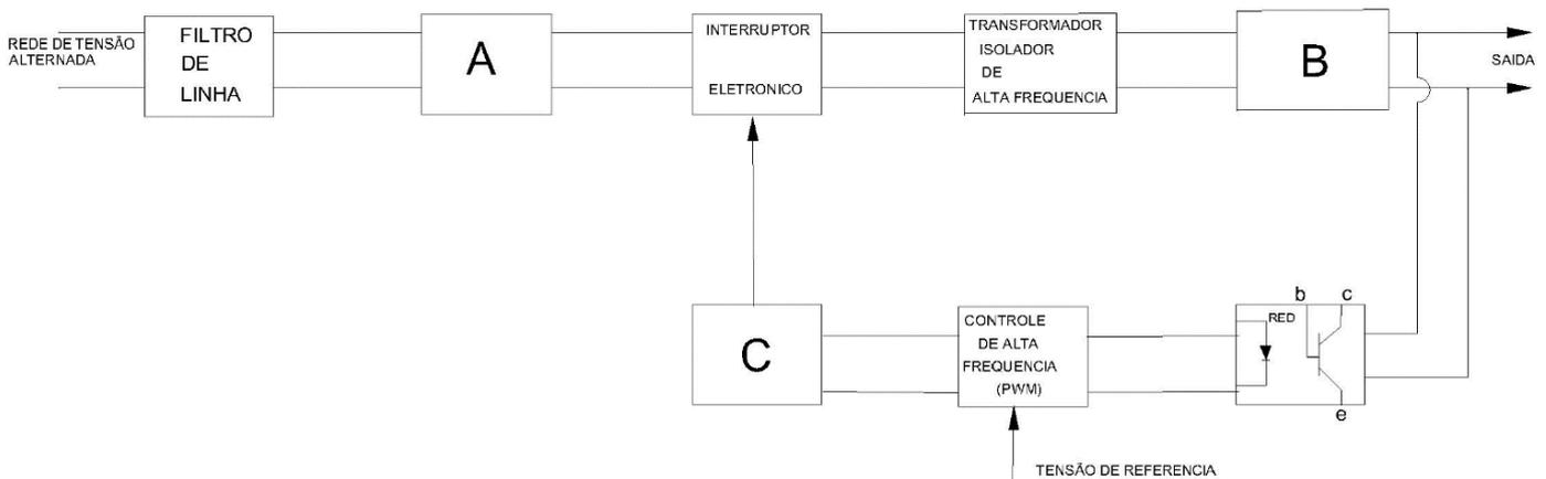
Associe a função dos blocos A, B e C relacionados na coluna da esquerda com a função operacional na coluna da direita, para que este diagrama fique corretamente demonstrado.
