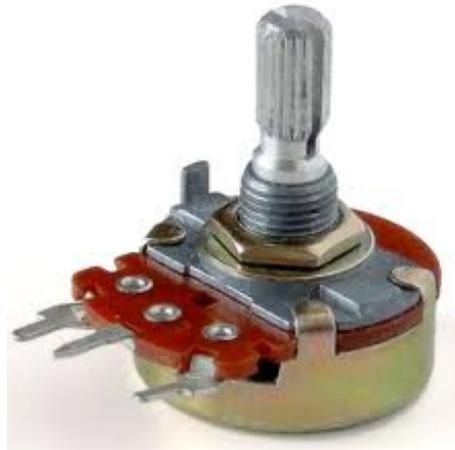
O equipamento mostrado na figura acima chama-se Potenciômetro. Este equipamento é muito utilizado nos circuitos eletro-eletrônicos. O símbolo mais adequado para representar este equipamento é o apresentado na alternativa
