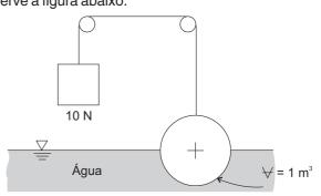
Uma esfera de volume igual a 1 m³ flutua semi-submersa em água e está ligada a um peso de 10 N em equilíbrio, conforme mostrado na figura. Nesta situação, é correto afirmar que, para manter a esfera flutuando, o peso utilizado:
