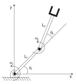
Considere o manipulador robótico com dois braços, duas juntas rotacionais com velocidades constantes  $(\omega_1 e \omega_2)$  e uma garra, em uma configuração  $(\theta_1 e \theta_2)$  qualquer.
