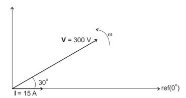
Com base nos fasores de tensão e corrente de uma fonte alternada senoidal, apresentados na figura, os valores das potências ativa, reativa e aparente, respectivamente, são:
