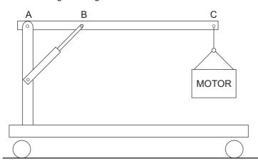
O projeto da viga ABC do guindaste de motores da figura requer a determinação dos esforços internos atuantes em cada um de seus trechos, AB e BC.
