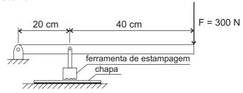
Se o operador do dispositivo aplica uma força F = 300 N à alavanca, a força da ferramenta de estampagem sobre a chapa, expressa em newtons, vale:
