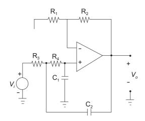
O circuito da figura acima mostra um amplificador ideal alimentado em sua entrada pelo sinal de tensão Vi e tendo como saída o sinal de tensão Vo. Este circuito é identificado como um filtro do tipo
