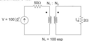
O número de espiras do lado de baixa tensão, que garantirá a máxima transferência de potência à carga e a corrente no lado de baixo da tensão são, respectivamente:
