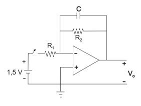
O circuito da figura acima mostra um amplificador ideal alimentado em sua entrada por uma fonte de tensão contínua. Os componentes são C=12  $\mu$ F, R,= 1,2  $k\Omega$  e  $R_0$ =6 k $\Omega$ . A chave é fechada e, quando o circuito atinge o regime permanente, a tensão Vo, em volt, vale
