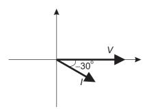
A figura acima apresenta um diagrama fasorial de uma tensão cujo módulo é |V| = 120 V e de uma corrente de módulo |/| = 3 A, gerada quando a tensão V é aplicada sobre uma impedância.
