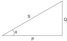
Neste triângulo, a potência aparente S é igual a 100 VA e seu fator de potência inicial é de 0,86 indutivo ( $\phi$  = 30°). Este fator de potência é então corrigido para 0,92 indutivo (\$\phi = 23\circ\$) por meio da instalação de capacitores, que totalizam uma injeção de potência reativa de aproximadamente 11 var. O valor final aproximado da potência reativa, em var, após a correção do fator de potência no circuito, é
