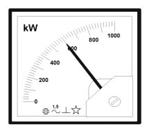
A figura acima mostra o wattímetro indicando uma medição 600 kW. Com base nas indicações do display, a tensão de prova do instrumento e a faixa em que a potência real pode variar são, respectivamente:
