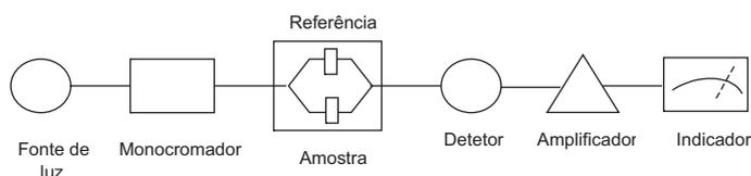
Sobre o esquema acima, que representa um espectrofotômetro utilizado para medir a absorção de soluções na faixa de luz UV-visível, pode-se afirmar que:
