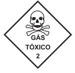
Durante as operações de carga, transporte, descarga, transbordo, limpeza e descontaminação, os veículos e equipamentos utilizados no transporte de produtos perigosos deverão portar identificação, conforme as figuras acima, que mostram, respectivamente, o(a)
