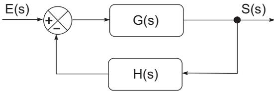
O controle de um processo é representado pelo diagrama de blocos acima, onde  $E(s)$  é a entrada,  $S(s)$  é a saída,  $G(s)$  é a função de transferência do processo a ser controlado e  $H(s)$  é a função de transferência do controlador. Considerando-se uma realimentação unitária, a função de transferência do sistema com o controlador,  $FT = S(s)/E(s)$ , é expressa por
