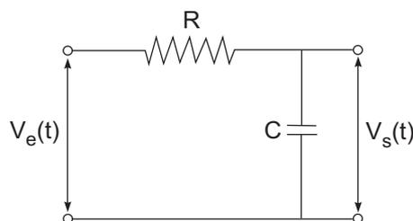
O circuito passivo, mostrado na figura acima, representa a configuração de um filtro passa-baixa, onde entra um sinal em tensão  $v_e(t)$  e sai um sinal  $v_s(t)$ . Os elementos lineares resistor  $R$  e capacitor  $C$  desse circuito são, respectivamente,
