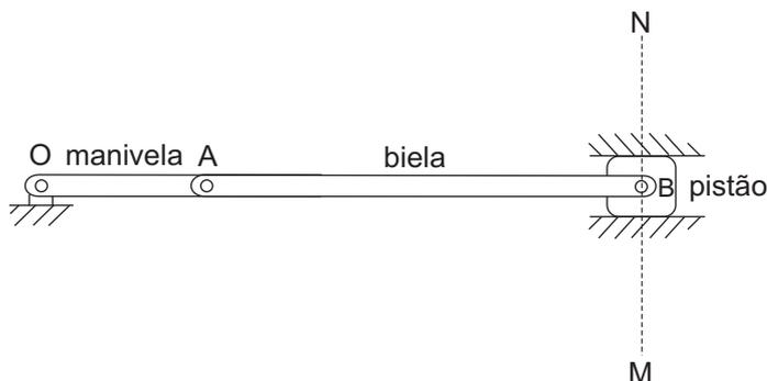
Considere o mecanismo biela-manivela-pistão de um motor a combustão na configuração mostrada na figura acima. Se, nessa fase, a velocidade angular da manivela é constante, a segunda Lei de Newton estabelece que a resultante das forças aplicadas ao pistão tem direção
