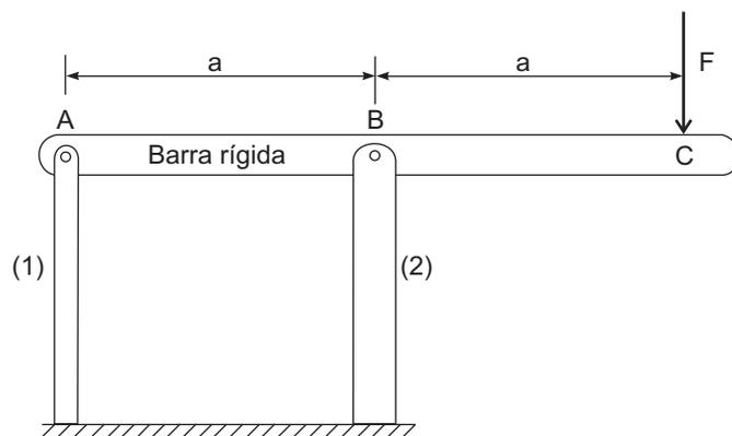
Considere a estrutura mostrada na figura acima, constituída de uma barra rígida ABC e de duas barras flexíveis, (1) e (2), de mesmo material, mesmo comprimento e áreas que obedecem à relação  $A_2 = 2A_1$ . A estrutura sofre a ação de uma força  $F$  gradualmente crescente, atuante em C. Se o material utilizado na fabricação das barras flexíveis for dúctil, com tensão de escoamento  $\sigma_y$  (tração e compressão), ao se atingir esse valor de tensão na barra
