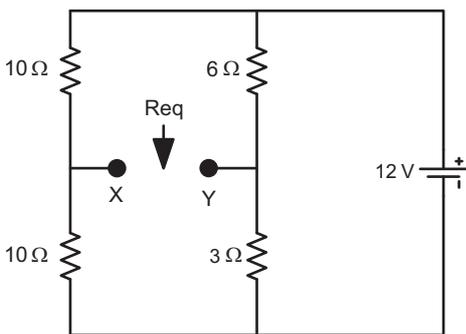
Para o circuito apresentado na figura ao lado, o valor da resistência equivalente  $Req$ , vista pelo par de terminais X e Y, será
