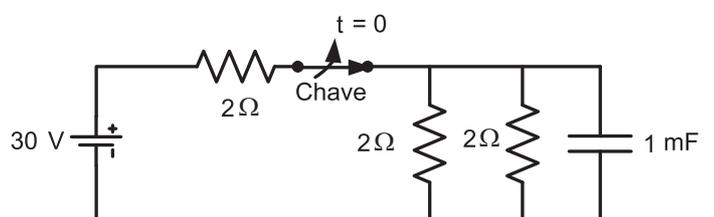
O circuito acima está operando há longo tempo com a chave fechada. Em  $t = 0$ , a chave abre, interrompendo o circuito. Imediatamente após a abertura da chave, a tensão nos terminais do capacitor, em volts, será igual a
