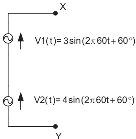
Um eletricitista de uma companhia petroquímica, para atender a uma emergência, precisa associar em série duas fontes geradoras de tensão alternada, disponíveis no momento. Não há nenhum impedimento técnico em fazer esse tipo de ligação, que é mostrada na figura acima. A tensão resultante apresenta a seguinte expressão  $V_{XY}(t) = A \sin(2\pi 60 t + \theta^\circ)$ . O valor de  $A$ , em Volts, e  $\theta^\circ$ , em graus, será, respectivamente,
