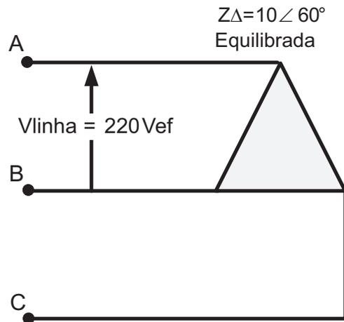
Uma linha trifásica de 220 Vef, sequência A-B-C, mostrada na figura acima, alimenta uma carga equilibrada ligada em triângulo ( $\Delta$ ) com  $Z_\Delta = 10 \angle 60^\circ$ . Dentre os intervalos de potência abaixo, qual apresenta o valor da potência ativa total (trifásica) dissipada na carga trifásica  $Z_\Delta$ ?
