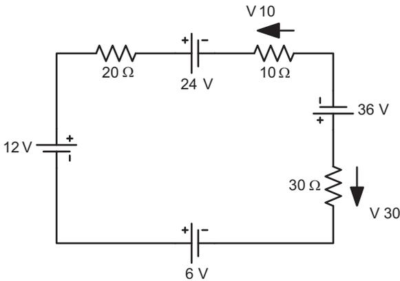
No circuito mostrado na figura ao lado, as tensões sobre os resistores de 10 Ω e 30 Ω são representadas por  $V_{10}$  e  $V_{30}$ , respectivamente. Sabendo-se que todos os elementos do circuito são ideais, o valor das tensões  $V_{10}$  e  $V_{30}$ , indicadas sobre os respectivos resistores, são
