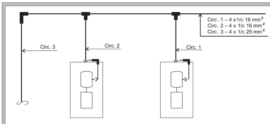
A representação gráfica acima pertence a uma instalação elétrica para alimentação através de condutores elétricos, de dois conjuntos motor-bomba. De acordo com a NBR 5410, a Taxa Máxima de Ocupação, TMO, dos eletrodutos que contém os circuitos, é de
