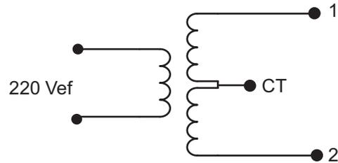
Um transformador monofásico com dois enrolamentos secundários (1 e 2) e tomada central CT é submetido a uma tensão primária de 220 Volts eficazes, conforme mostrado no circuito acima. A relação de espiras para cada enrolamento secundário é 5:1. Nessa condição, a tensão secundária eficaz, de cada enrolamento (1 e 2), em relação ao CT, será
