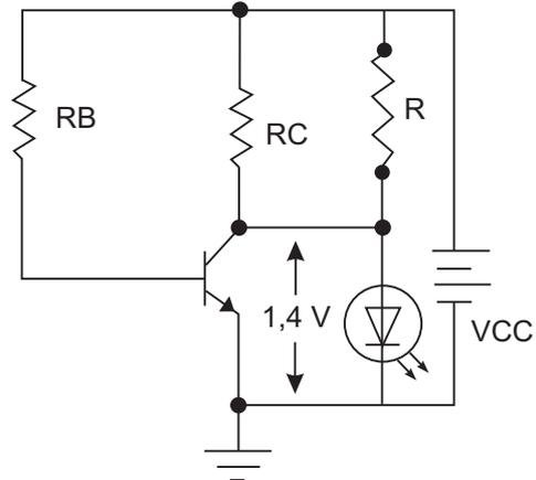
Considerando, no circuito apresentado acima, que  $V_{CC} = 12\text{ V}$ ,  $H_{fe} = 100$ , corrente em  $R = 20\text{ mA}$ ,  $V_{be} = 0,7\text{ V}$ ;  $I_b = 400\mu\text{ A}$  e desconsiderando os valores comerciais dos resistores, os valores de  $R$ ,  $R_B$ ,  $R_C$  para o led apagado são, em ohms, respectivamente,
