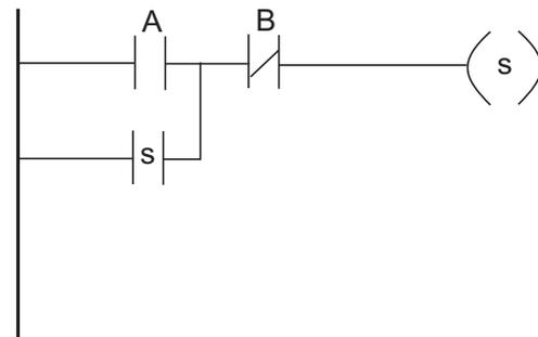
Com a mudança de estado do bit A, a função do bit S, em paralelo com o bit A, é
