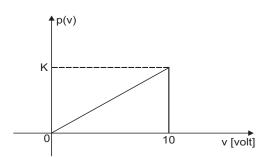
Um sinal aleatório de tensão é representado pela variável aleatória v, que varia no intervalo de 0 a 10V segundo a função p(v) (Função Densidade de Probabilidade), definida pela curva da figura acima. Sabe-se que o valor eficaz ou rms dessa tensão é calculado pela expressão  $V_{rms} = \sqrt{E \left[ v^2 \right]}$ , onde  $E[v^2]$  é a Expectância (ou o Valor Esperado) da tensão ao quadrado.
