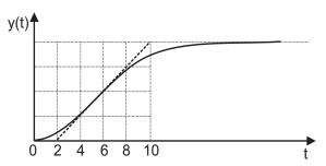
Para sintonizar, pelo primeiro método de Ziegler Nichols, o controlador PID aplicado a uma planta, utilizam-se medidas experimentais da resposta ao degrau da planta em malha aberta, conforme mostra a figura acima. A função de transferência do modelo do PID é H(s) =  $K_p \left(1 + \frac{1}{T_i s} + T_d s\right)$ , onde os parâmetros são obtidos da tabela a seguir, e T e L são extraídos do gráfico da resposta ao degrau, mostrada na figura.
