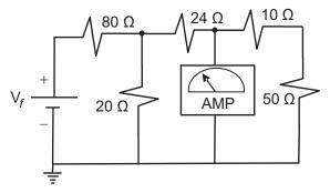
O amperímetro montado no circuito da figura acima, onde os componentes são considerados ideais, mede uma corrente de 0,8 A.
