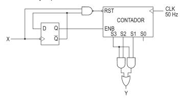
O sinal digital X é produzido por um sensor posicionado na pista do velódromo. Quando uma bicicleta passa pelo sensor, o sinal X apresenta dois pulsos de nível lógico alto nos instantes em que cada roda toca o sensor, conforme mostra o gráfico a seguir.
