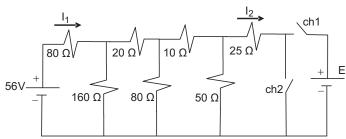
Tome por base o circuito CC da figura acima, onde todos os componentes são considerados ideais. Com a chave **ch2** fechada e a **ch1** aberta, as correntes são:  $I_1 = 0.5A$  e  $I_2 = 0.2A$ . Com a chave **ch1** fechada e a chave **ch2** aberta, o valor da corrente  $I_1$  cairá para 0.1A.
