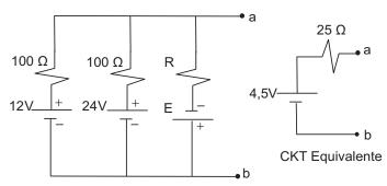
Os componentes do circuito mostrado na figura acima são considerados ideais. Combinando as três fontes, com seus respectivos resistores, resulta o circuito equivalente, entre os pontos a e b, mostrado no lado direito da figura.
