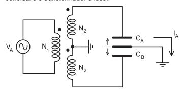
Partindo do ponto médio entre as duas placas fixas, desloca-se a placa móvel do arranjo.
