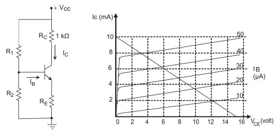
A figura acima mostra um circuito eletrônico montado com um transistor bipolar NPN que está polarizado para funcionar de acordo com a reta de carga traçada sobre a curva característica aproximada do transistor.
