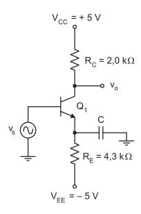
Considerando que o transistor  $Q_1$  apresenta uma tensão  $V_{BE}$  = 0,7 V, um parâmetro  $\beta$  muito elevado e uma tensão  $V_{CE}$  de saturação desprezível, a forma de onda que melhor representa a tensão na saída  $v_o$  do amplificador é
