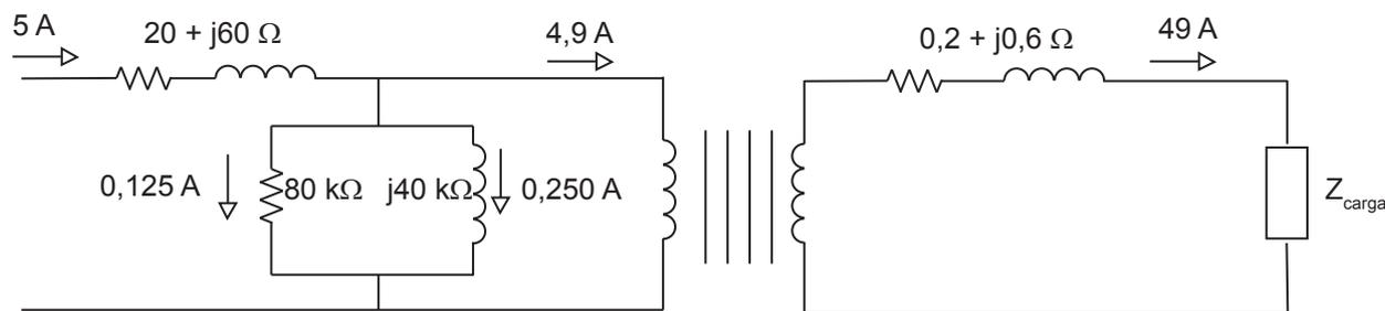
Diante do exposto, o valor das perdas do núcleo do transformador, em W, é
