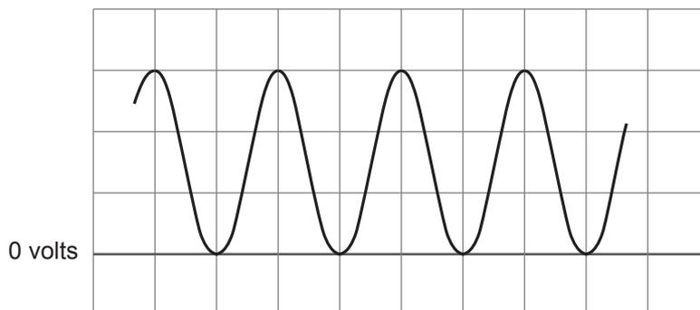
As escalas nas linhas de grade da tela do osciloscópio informam 10 *volts/div* em amplitude e 20  $\mu\text{s/div}$  na base de tempo.
