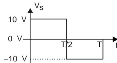
Qual o valor médio, em volts, da tensão  $V_R$  na carga?
