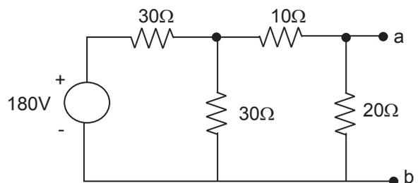
Qual a tensão, em volts, medida entre os pontos a e b desse circuito?
