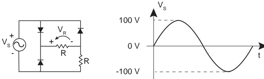
De acordo com a polaridade indicada e considerando-se os diodos ideais, qual será a forma de onda na tensão da carga?
