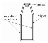
A figura acima mostra uma garrafa com dupla parede para armazenamento de líquidos quentes ou frios. As paredes são feitas de material espelhado e há vácuo no espaço entre elas. Considerando os processos de transferência de calor entre o interior e o exterior da garrafa, julgue os itens a seguir.
