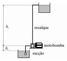
O sistema de bombeamento esquematizado na figura acima opera com um rendimento total de 80% e bombeia água à razão de 0,02 m³/s. Considerando esse sistema, e que a massa específica da água seja 1.000 kg/m³, julgue os itens seguintes.
