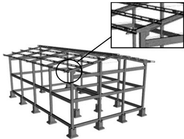
Figura II: Esqueleto estrutural em concreto e aço
