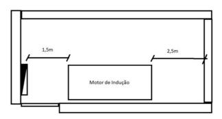
O esquema precedente mostra o posicionamento de um motor elétrico de indução, localizado dentro de uma sala. Considerando que o esquema não está em escala, mas apresenta as dimensões relevantes para a análise, julgue os itens subsequentes.
