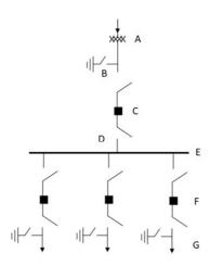
Considerando a figura precedente, que apresenta o arranjo de uma subestação abaixadora de tensão, julgue os próximos itens, a respeito dos equipamentos e do funcionamento de uma subestação.
