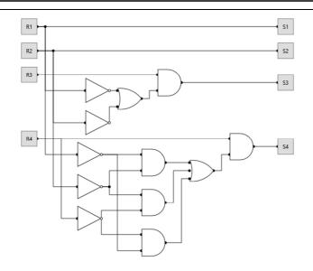
O circuito digital representado faz o controle de acionamento de uma central telefônica que possui quatro ramais. As entradas R1, R2, R3 e R4 significam que o respectivo ramal solicitou uma ligação à central. As saídas S1, S2, S3 e S4 indicam se a ligação foi completada pela central ou não. Considerando esse circuito e as informações apresentadas, julgue os itens a seguir.
