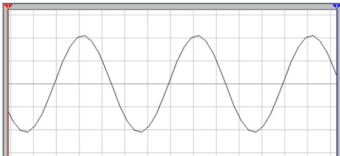
Sabendo que o instrumento está configurado na escala VOLTS/DIV em 200mV/div e na escala TIME/DIV em 2ms/div, é correto afirmar que a tensão de pico e a frequência desse sinal valem, respectivamente,
