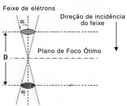
**14.** Abaixo estão representadas esquematicamente, três das principais aberrações que podem ocorrer nas lentes eletromagnéticas de um microscópio eletrônico de varredura.
