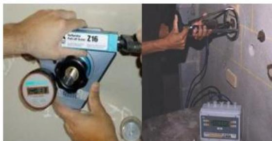
Figura ensaio utilizando arrancador de argamassa
