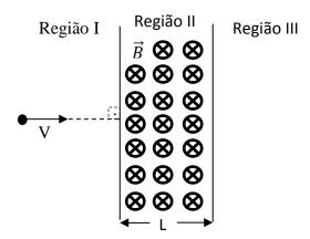
A região II tem um campo magnético uniforme B, indicado na figura, perpendicular ao plano do papel. O comprimento da região II é L. Verifica-se que
