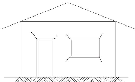
As trincas que normalmente aparecem em aberturas nas paredes de alvenaria são causadas por
