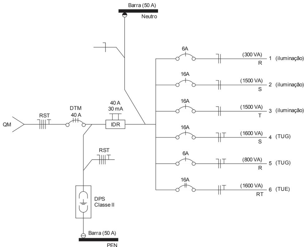
83. Considere o esquema unifilar do quadro de distribuição residencial: O dispositivo identificado por IDR é um interruptor diferencial residual
