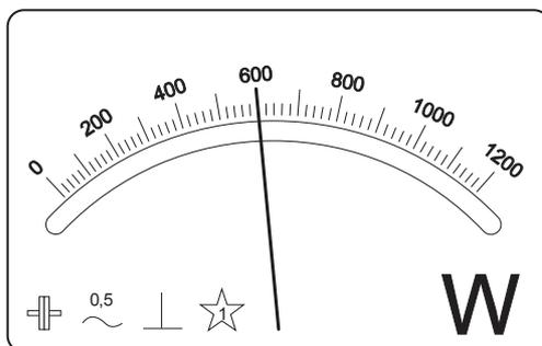
Na posição em que se encontra o ponteiro do wattímetro (600 W), considerando-se o erro de leitura do instrumento, o valor real da potência em W está entre:
