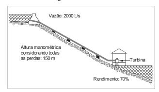
O sistema hidráulico fornece a vazão de 2000 litros por segundo à turbina cujo rendimento é 70%. Se a altura manométrica do sistema for 150 m, considerando todas as perdas, a potência da turbina, em CV, é
