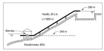
Para garantir a vazão de 25 litros por segundo em uma adutora foi construído um sistema de recalque com uma bomba hidráulica cujo rendimento é 80%. As cotas de projeto à montante e à jusante são, respectivamente, 245 m e 290 m. O comprimento da tubulação é 1850 m. Se a perda de carga em todas as singularidades existentes no sistema for 25 m e a perda de carga unitária for 0,008 m/m, a potência da bomba, em CV, é
