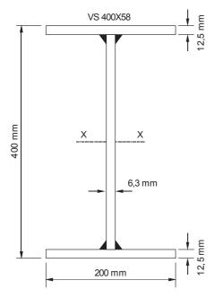
Considerando que o módulo plástico da seção transversal em torno do eixo X-X seja de 1190 cm³, o momento resistente de cálculo desta viga, em kNm, é
