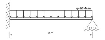
Se a viga receber uma carga uniformemente distribuída de 20 kN/m ao longo de seu comprimento, então os valores máximos dos momentos fletores que tracionam as fibras superiores e inferiores, em kNm, serão, respectivamente,
