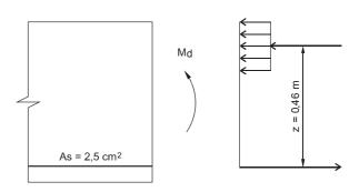
Considerando que a área da seção transversal de armadura de tração em aço CA-50 é de 2,5 cm² e o braço de alavanca entre a resultante das forças de compressão e de tração na flexão é 0,46 m, o momento fletor resistente de cálculo, em kNm, é
