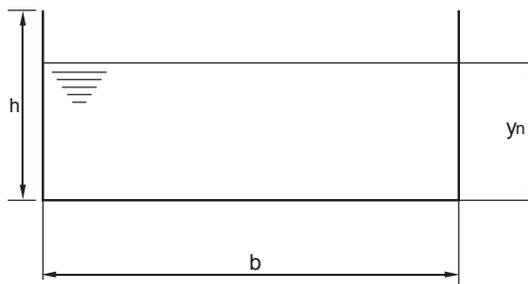
Sabendo que o canal tem dimensões ( $b \times h$ )  $5,0 \text{ m} \times 7,0 \text{ m}$  e a altura da lâmina d'água ( $y_n$ ) é igual a  $3,5 \text{ m}$ , a área, em  $\text{m}^2$ , e o raio hidráulico, em  $\text{m}$ , característicos do escoamento são, respectivamente, iguais a
