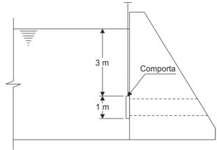
Para o projeto de uma pequena barragem de concreto em uma fazenda foi necessário instalar uma comporta vertical quadrada  $1 \text{ m} \times 1 \text{ m}$  de ferro fundido, cujo topo encontra-se a 3 m de profundidade do nível da água. Considerando o peso específico da água  $10 \text{ kN/m}^3$ , a força resultante do empuxo que a água exerce na comporta é, em kN,
