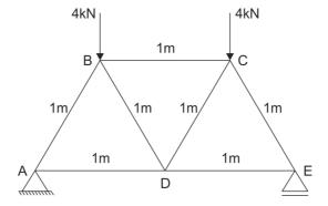
Considerando as cargas concentradas de 4 kN nos nós B e C, a barra AB está solicitada a uma carga, em kN, de
