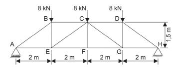
Para dimensionar o tipo de perfil a ser utilizado, foram calculadas as forças em todas as barras da treliça. A força atuante nas barras AB e AE são, respectivamente, em kN,
