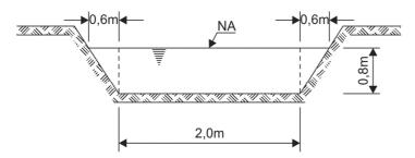
Um parâmetro importante no dimensionamento de canais, dutos, tubos e outros componentes das obras hidráulicas é o raio hidráulico, que nesse projeto, seu valor, em metros, é
