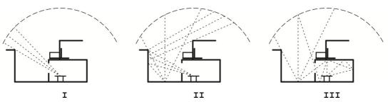
A figura acima distingue três caminhos básicos resultantes da divisão do fluxo luminoso admitido em três componentes. Tais caminhos, I, II e III, correspondem respectivamente às componentes:
