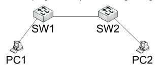
SW1 e SW2 são *switches Ethernet* de camada 2. PC1 e PC2 são computadores executando um sistema operacional com suporte a redes TCP/IP e Ethernet.
