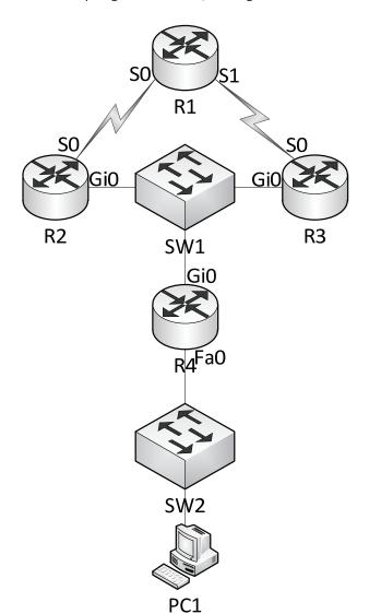
As conexões entre R1 e R2 e entre R1 e R3 são *links* dedicados ponto-a-ponto. A conexão entre R2, R3 e R4 é um *link* Ethernet Gigabit realizada por meio do switch SW1. A interface *FastEthernet* de R4 está conectada ao *switch* SW2 utilizando protocolo IEEE 802.1Q.
