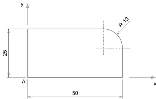
Para a execução do arredondamento indicado na figura, sabendo que a ferramenta está posicionada no ponto A, a linha de comando é
