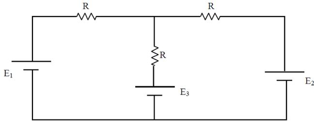
Sabendo-se que  $E_1 = E_2 = 20\text{ V}$ , para que a corrente elétrica no ramo central do circuito seja igual a zero, a tensão da fonte  $E_3$  deve ser, em volts, igual a
