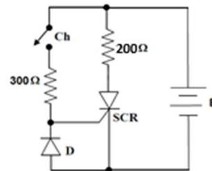
A potência dissipada no resistor de  $200\ \Omega$  é igual a
