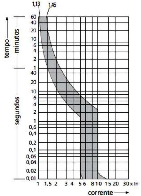
Sabendo-se que o valor da corrente de falta no circuito, devido ao contato da fase com o chassi do equipamento, é de 160 A, o tempo de exposição ao choque usuário é, em segundos, igual a
