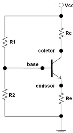
As correntes no emissor e na base são iguais a 5 mA e 0,5 mA. As diferenças de potencial nos resistores  $R_e$  e  $R_c$  são iguais a respectivamente a 10% e 30% de  $V_{CC}$ .
