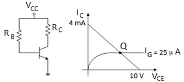
Sabendo que a tensão base-emissor do transistor é igual a 0,75 V, os valores dos resistores  $R_B$  e  $R_C$ , em kΩ, são, respectivamente, iguais a
