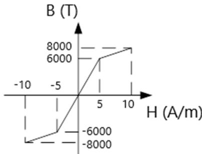
Sabendo-se que a permeabilidade magnética do vácuo é  $5\pi \times 10^{-7}$  H/m, a permeabilidade relativa do material na região saturada da curva é de
