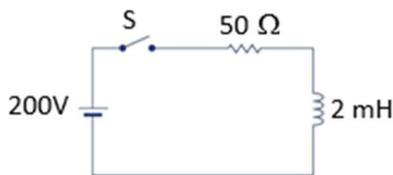
Assinale a opção que indica a corrente elétrica que flui no circuito acima após 0,2 s do fechamento da chave S.
