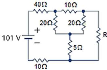
Para que o resistor de 5 Ω do circuito seja submetido a uma ddp de 5 V, o resistor R deve ter uma resistência de
