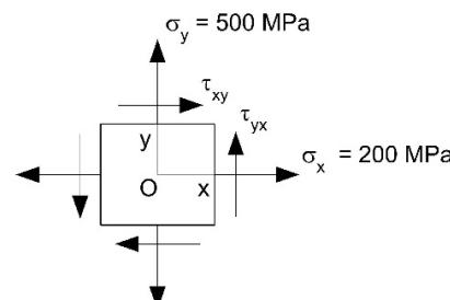
Sabendo que a tensão cisalhante admissível nessa seção vale 625 MPa, a máxima tensão cisalhante  $\tau_{xy}$  resistida por esse elemento vale
