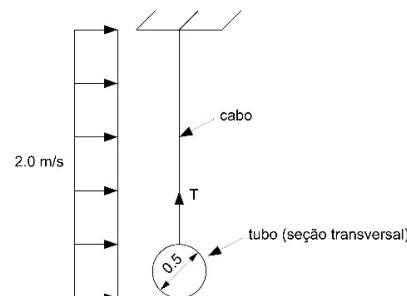
O tubo e o cabo estão imersos em água, com massa específica de 1000 kg/m<sup>3</sup>, e sob ação de uma corrente uniforme com velocidade constante de 2,0 m/s.
