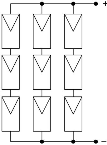
A figura acima apresenta um arranjo misto de módulos fotovoltaicos. Sabendo-se que a máxima tensão e a máxima corrente dos módulos são, respectivamente, 20 V e 5 A, a máxima potência de saída do módulo, em watts, é:
