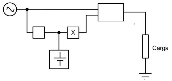
A figura acima mostra uma unidade de alimentação ininterrupta (UPS) estática, que alimenta uma carga em corrente alternada.
