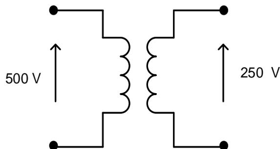
Um transformador monofásico 500 / 250 V, 10 kVA, mostrado na figura acima, será usado como autotransformador abaixador.
