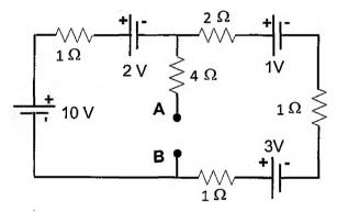
Esse circuito pode ser resumido a um circuito simples entre os pontos A e B, no qual uma fonte de tensão ideal (em Volt) pode ser ligada em série com uma resistência (em ohm), cujos valores são respectivamente:
