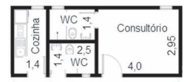
Sabendo-se que a espessura das paredes é 15 cm e que a altura de alvenaria é de 3,0 m, a quantidade de tijolo cerâmico de 9 x 19 x 29 cm a ser consumido nessa obra, desprezando-se os vãos de portas e janelas, é de, aproximadamente:
