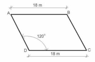
Se o rumo magnético do alinhamento A-B é 38° 42' SE, o azimute magnético do alinhamento B-C é:
