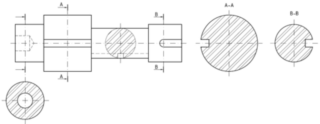
Assinale a alternativa que se refere à seção representada **incorretamente** segundo a NBR 10.067.
