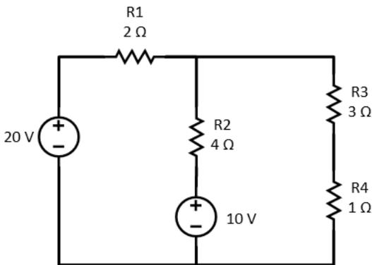
Assinale a alternativa que contém o módulo do valor aproximado das tensões em volts nos resistores 3 e 4, respectivamente.
