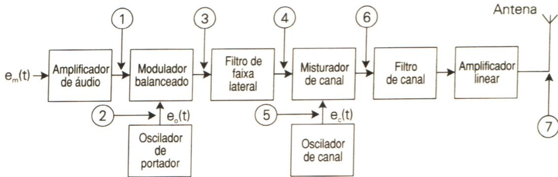
Utilizando a numeração do diagrama em blocos, identifique os espectros dos sinais ao longo desse transmissor.
