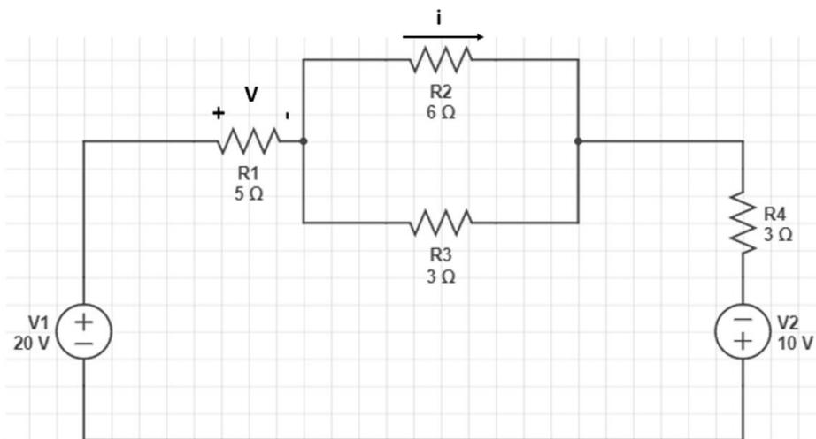
Assinale a alternativa que apresenta correta e respectivamente o módulo da tensão  $V$  no resistor  $R_1$ , em volts e da corrente  $i$  no resistor  $R_2$ , em amperes.
