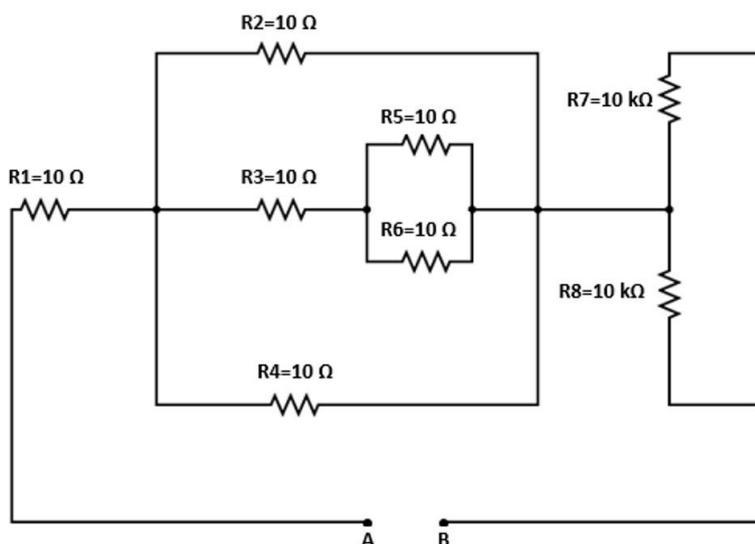
Considerando esse circuito, assinale a alternativa que indica o valor da resistência equivalente em relação aos terminais A e B.
