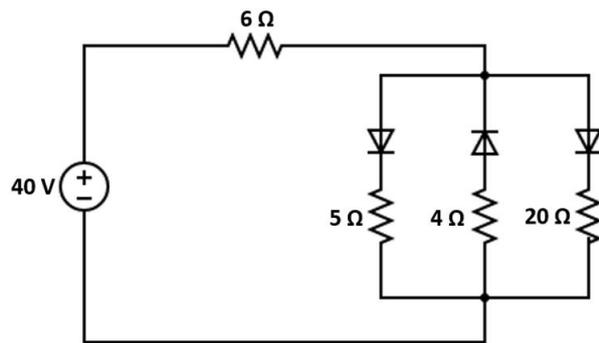
Os valores, em módulo, das correntes que circulam nos resistores de  $5\ \Omega$  e  $20\ \Omega$  são, respectivamente:
