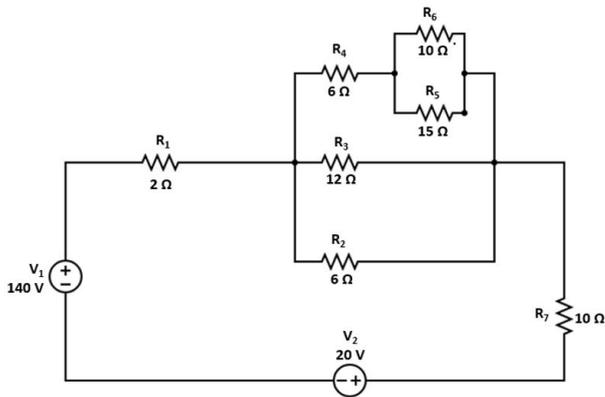
Assinale a alternativa que apresenta corretamente o módulo da potência  $P$  no resistor  $R_2$  em watts e da tensão  $V$  no resistor  $R_5$  em volts.
