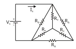
Além das associações série e paralelo, a conexão de elementos em estrela e em triângulo é muito comum em circuitos elétricos, sejam eles monofásicos ou trifásicos. Utilizando as transformações apropriadas, assinale a alternativa que apresenta a expressão correta para o cálculo da corrente  $I_{\rm S}$  no circuito CC ilustrado acima, considerando que  $R_{\rm Y}=R$  e  $R_{\Delta}=2R$ .
