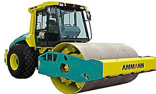
Esta máquina é indicada para realizar acabamento de compactação de solo, após utilização do rolo pata, para compactar pedra, areia entre outros materiais. Trata-se do(da):
