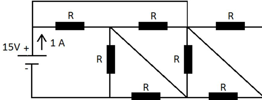
Determine o valor da resistência  $R$  para que a fonte forneça uma corrente de 1 A.
