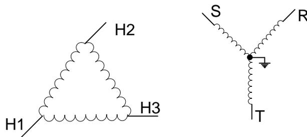
Sabendo-se que a tensão nas bobinas de alta tensão H1, H2 e H3 é de 13,8 kV e no secundário é de 220 V entre fases, determine as correntes aproximadas no cabo de alta tensão e baixa tensão, respectivamente, em um transformador de 75 kVA. (considere  $\sqrt{3} = 1,7$ )
