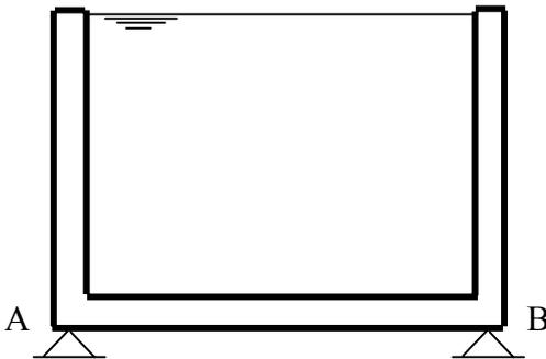
A armadura mais adequada que deve ser colocada no nó A deste reservatório (encontro da parede e da laje do fundo) deve ser a seguinte:
