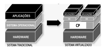
O componente identificado por CP representa um software utilizado para realizar o gerenciamento das VMs, funcionando em uma camada entre o hardware e o sistema operacional, sendo, desta forma responsável por fornecer ao sistema operacional a abstração da máquina virtual e por controlar o acesso dos sistemas operacionais convidados aos dispositivos de hardware.
