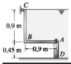
Aágua de um canal é retida por uma comporta com largura de 150mm, que é suportada por um pino em A e um rolete em C, e a parede vertical AD é construída no fundo do canal. Assim, se a comporta tem peso desprezível, e o peso específico da água é de um quilograma força por litro, então as reações de apoio horizontais são  $H_A$  = 81,0kgf e  $H_C$  = ± 20,25kgf e as reações verticais dos apoios da comporta são  $V_A$  = 121,5kgf e  $V_C$  = 0,0kgf.
