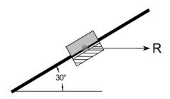
Considere a figura apresentando um colar de 3,5kg, que se movia para baixo, na barra, com velocidade de 3m/s, quando a força R foi aplicada no cabo horizontal.
