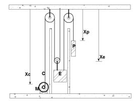
O elevador E, ilustrado, sobe com uma velocidade constante de 20,0m/s, e, pela configuração do sistema apresentado, a velocidade relativa entre o cabo C e o elevador E será de 60m/s para baixo.
