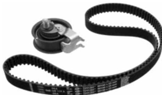
A figura mostra uma correia dentada e um esticador de correia, que são utilizados na maioria dos veículos. Caso a correia dentada venha a partir, quebrar, durante o funcionamento do motor, poderá
