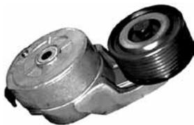
Ela mostra um tensor instalado na maioria dos veículos automotores. Caso ele trave ou quebre o rolamento, poderá quebrar
