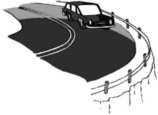
Ela mostra um veículo executando uma curva para direita. Caso ele execute essa manobra em alta velocidade, poderá ser arremessado para o lado contrário, esquerda, em função da força
