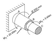
Se o momento polar de inércia da seção transversal do trecho AB é de 15000 cm<sup>4</sup>, então, a tensão de cisalhamento devido à torção nesse trecho é de
